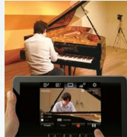
Die Kamera auf der Bühne kann z.B. von einem Tablet ferngesteuert werden. Die Bedienelemente beinhalten REC / STOP, Zoom, Focus, Iris und weitere detaillierte Einstellungen, während Live-Bilder vom Smart Device Display angezeigt werden.
