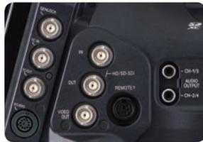
Abbildung zeigt die GY-HM890RE. Der SDI-Eingang und die Studio-Anschlüsse sind für den GY-HM850RE nicht verfügbar.
